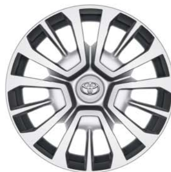
17"-Stahlfelgen mit Radzierblende mit Bereifung in 215/60R17
