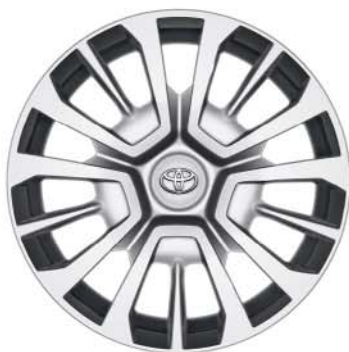
16"-Stahlfelgen mit Radzierblende mit Bereifung in 215/65R16
