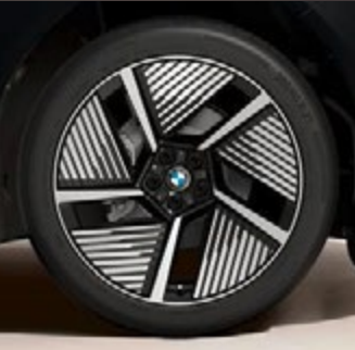
3NL 21" Aerodynamikräder 1049 Bicolor Alu-Gussrad, Jetblack Uni, glanzgedreht, Aerodynamik- einleger aus Aluminium
