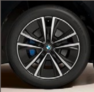
3NH 20" M Aerodynamikräder 1047 M Bicolor Alu-Gussrad, glanzgedreht, Aerodynamikeinleger aus Kunststoff
